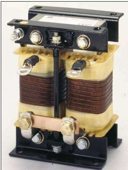
Rys. 4. Dławik ED1W filtru wygładzającego z rdzeniem zamkniętym typu EI
