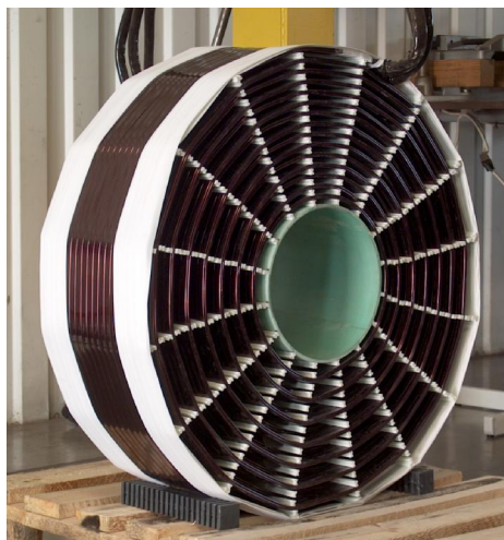
Рис.3 Многослойная катушка без сердечника – один из элементов трехфазной конструкции
