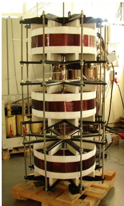
Рис.1 Трехфазный индукционный элемент без сердечника в процессе испытаний EP3 - 2мН / 540А / 6кВ
