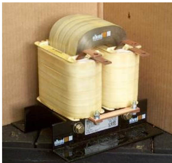
Рис.1. Сглаживающий дроссель типа AD1W ( 0,5\text{мГн} / 70\text{ADC} , f_k=10\text{кГц} ) на сердечнике из аморфного материала
