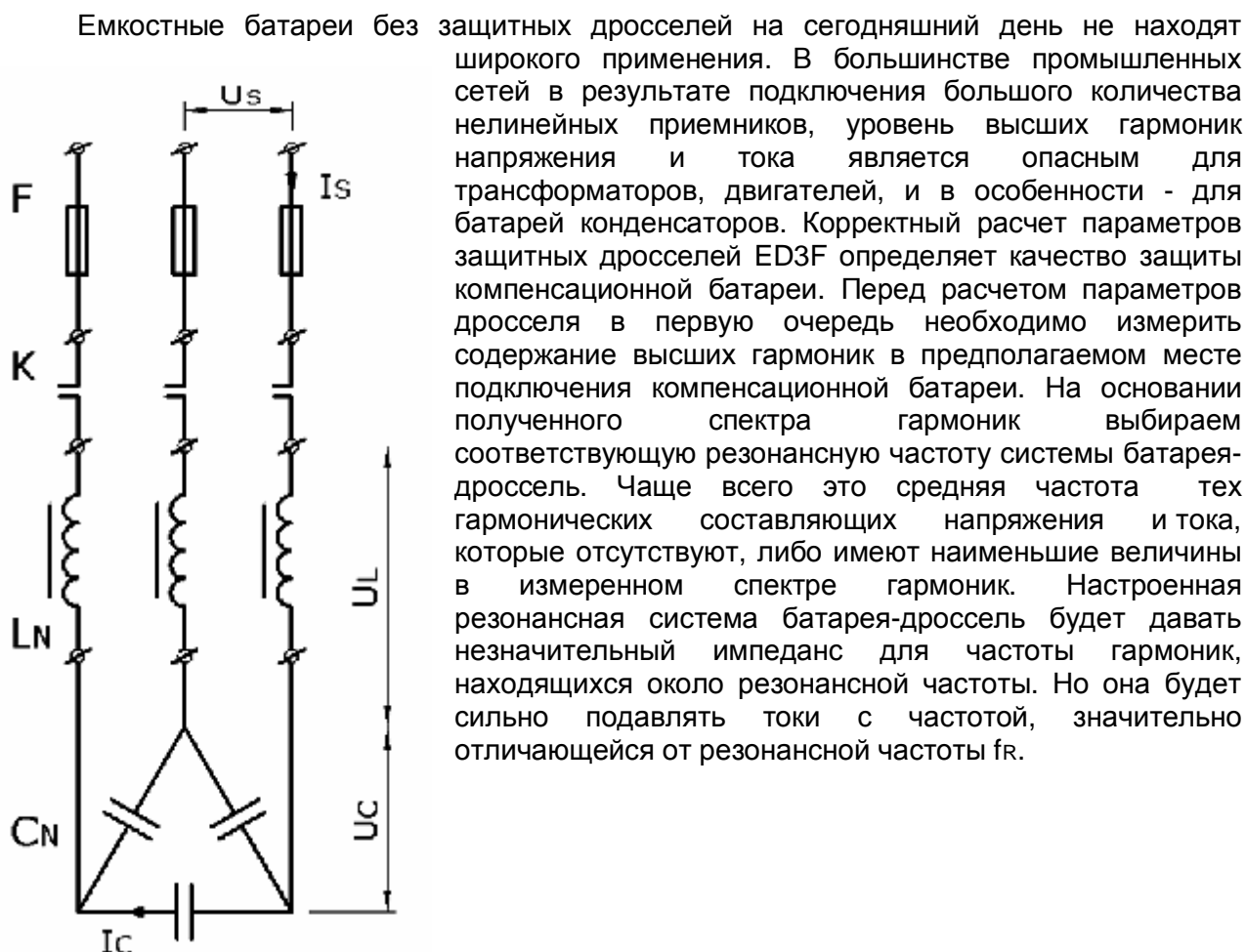
Рис.1 Схема одной ступени компенсационной батареи с подавляющими дросселями.
