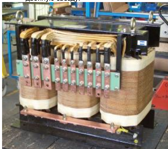
рис.6 Выпрямляющий 6-фазный трансформатор в схеме двойной звезды.
